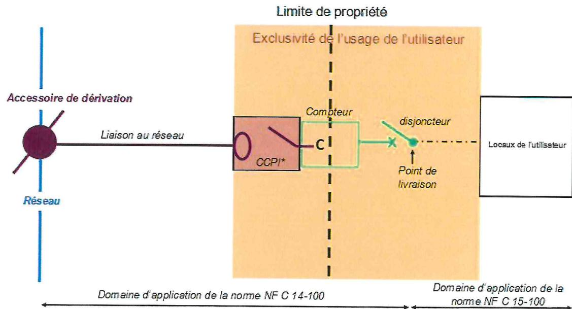
La liaison en partie privative en aval du point de livraison est entièrement réalisée par le demandeur, elle ne fait pas partie des ouvrages de distribution publique et doit être conforme à la norme NF C 15-100.
