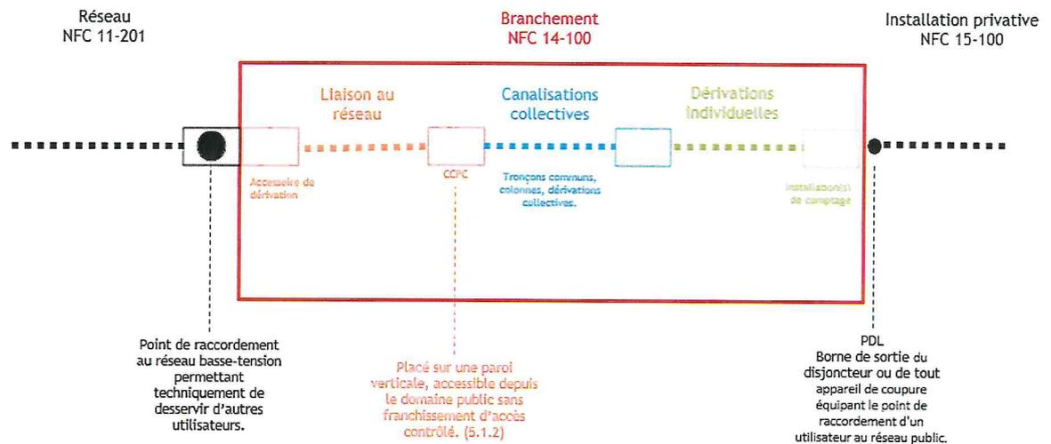
Dans certains cas et selon l'intérêt de l'utilisateur, le point de raccordement sera situé à l'intérieur de la copropriété, en pied de bâtiment, sans franchissement d'accès contrôlé.
